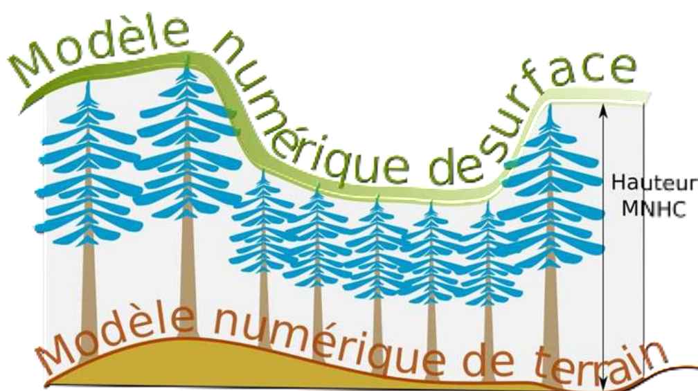
Figure 7 : la différence entre le modèle numérique de surface obtenu par corrélation d'images aériennes et le modèle numérique de terrain constitue le modèle numérique de hauteur de canopée (MNHC), qui décrit la hauteur des arbres
