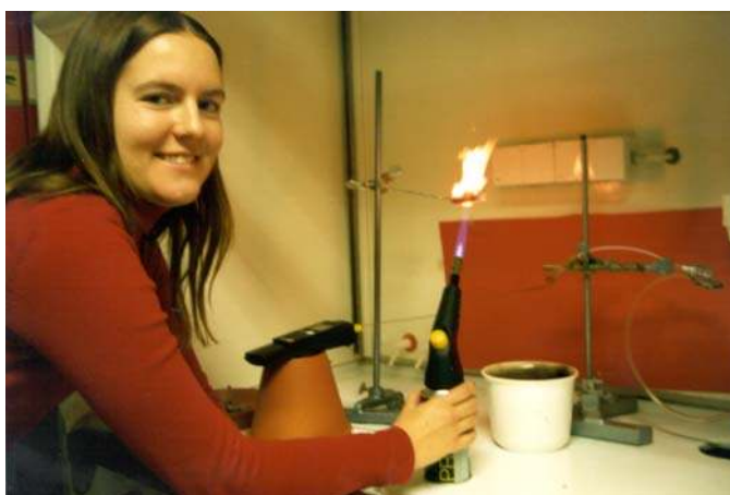
Fig. 5.2: Maria antänder pellets med butanbrännare före provtagning
