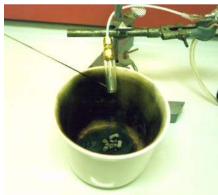
Fig. 5.3: Provtagning på glödande pellets
