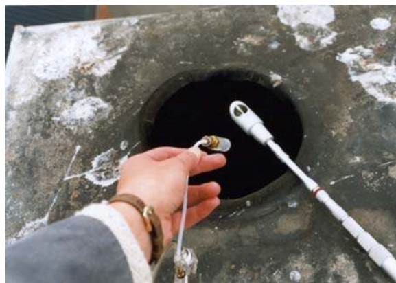
Figur 5.8 : Provtagning i skorstensmynningen.
