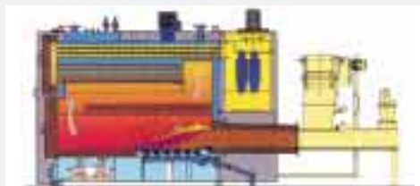
Chaudière à déchets de bois humides, alimentation par poussoirs hydrauliques.
