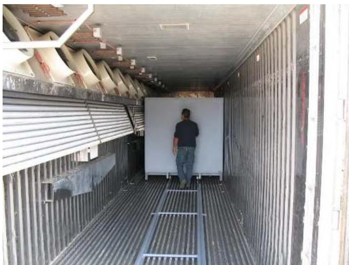
Figure 8 : Intérieur d'un caisson de séchage Eberl © Eberl
