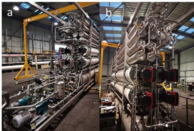
Figure 16 : VALORDIG en cours de finitions dans les ateliers de NEREUS a) vu depuis l'intrant et b) vu du côté du perméat final
