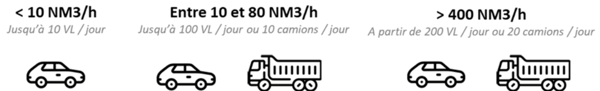
Figure 1 : ordre de grandeur du débit des compresseurs en fonction du nombre de véhicules s'y avitaillant pour une station à charge rapide
