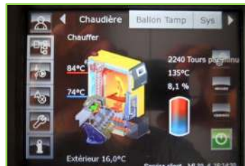
Gestion de l'ensemble des circuits de chauffage par la régulation de la chaudière
