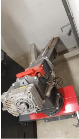
Un système de vis sans fin automatique et programmable transporte les plaquettes de bois jusqu'à la chaudière.
