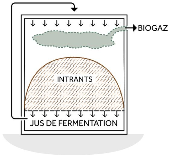
Les intrants sont mélangés avec du digestat sortant du lot précédent pour les inoculer. Les matières y sont laissées en tas durant tout le processus de décomposition et sont aspergées de jus de fermentation. Ces jus sont récupérés sous le tas, pompés, chauffés et aspergés sur les matières en décomposition afin de les inoculer, les maintenir humides et de limiter la formation de poches acides.
