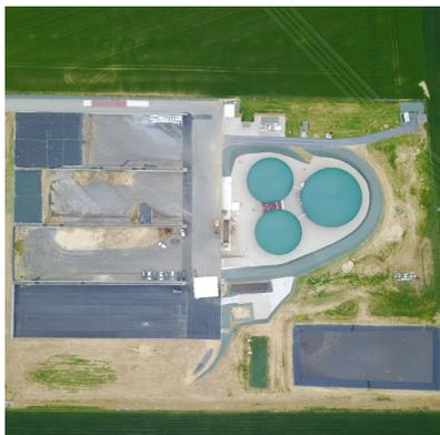
Avec 30 tonnes d'intrants ingérées par jour, l'unité BLB GAZ produit actuellement **11 000 m<sup>3</sup> de digestat par an**, nécessitant une surface d'épandage de 1 800 ha. A terme, les 22 000 m<sup>3</sup> de digestat devraient représenter une économie du poste engrais d'environ 50%.
