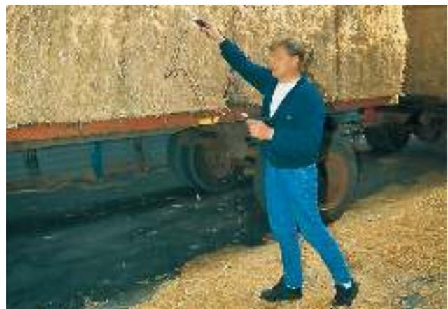
La teneur en humidité de la paille est contrôlée avant le déchargement. Si la teneur en eau est supérieure à 25%, elle n'est pas introduite dans la chaudière. PHOTO Torben Skøtt, BioPress.
