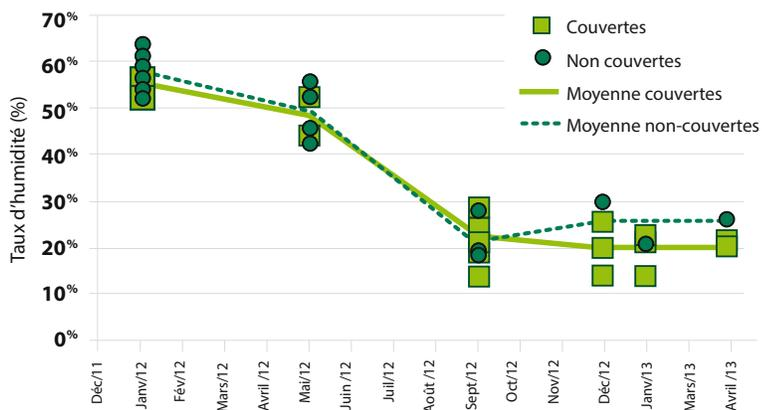
**Figure 3. Courbe de séchage naturel pour les piles couvertes et non couvertes (contrôles)**
