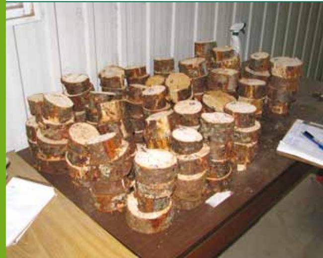
**Disques échantillons pour déterminer le taux d'humidité initial en janvier 2012**
