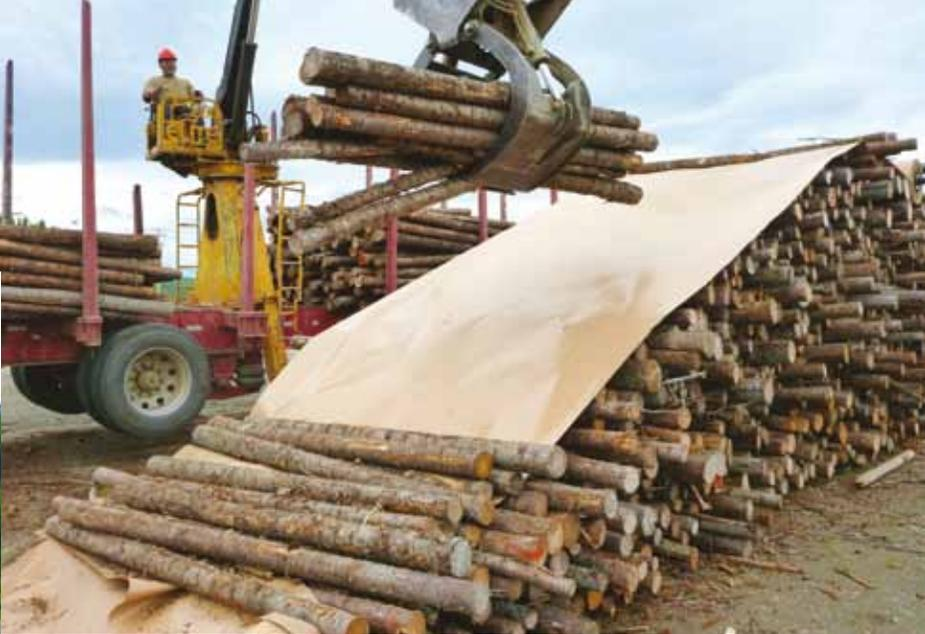
**Figure 2. Opération pour couvrir les piles de bois rond avec des bâches de protection à base de papier en septembre 2012**
