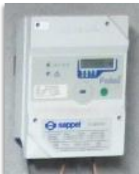
Compteur d'énergie hydraulique
