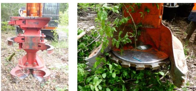
Figure 5 : Tête à cisaille et tête à disque
