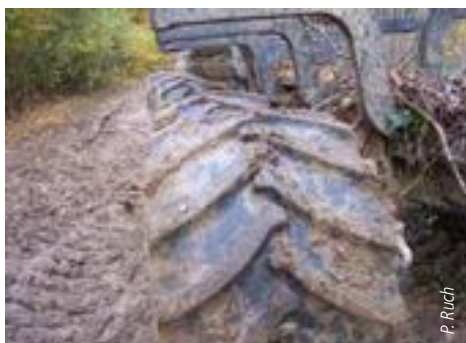
Porteur équipé de pneumatiques en 710 mm à l'avant et en 800 mm à l'arrière
