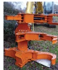
Une butée (ou contre-lame) fixe le tronc qui est sectionné par une lame
