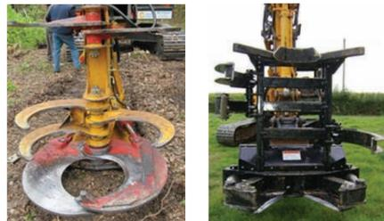
Deux lames s'entrecroisent et sectionnent le tronc perpendiculairement à l'axe du grappin
