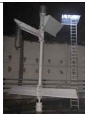
L'agitation se fait par **un agitateur à moteur extérieur avec un arbre vertical immergé**. Celui-ci est constitué de 4 pâles : 2 pâles en partie haute pour **éviter la formation d'une croûte en surface** et 2 pâles en partie basse afin de **réduire la sédimentation en fond de fosse**. Le moteur électrique étant à l'extérieur, la maintenance de l'appareil est grandement facilitée. Le nombre de phases d'agitation et leur durée sont gérés par l'automate.
