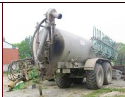
Cependant, afin d'éviter la volatilisation de l'azote ammoniacal lors de l'épandage du digestat, l'utilisation **d'épandeurs avec injecteurs ou pendillards** est fortement recommandée.
