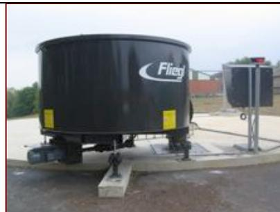
**Les substrats sont incorporés par petites doses et de façon régulière** (environ toutes les 2 heures), pour permettre la meilleure digestion possible par les bactéries. **Le brassage est simultané à l'incorporation**, afin de bien mélanger la matière solide avec le liquide et d'éviter ainsi **la formation de blocs ou d'une croûte de matières solides à la surface du digesteur**.
