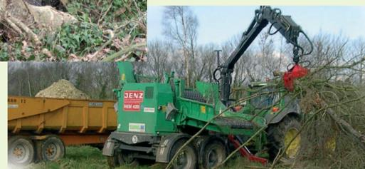
Déchetageuse à grappin : les débits de chantier machine varient de 15 à 45 m<sup>3</sup>/h (4 à 8 m<sup>3</sup>/h pour broyeur manuel). Le coût d'un broyeur à grappin varie de 80 à 250 €/h selon ses capacités.
