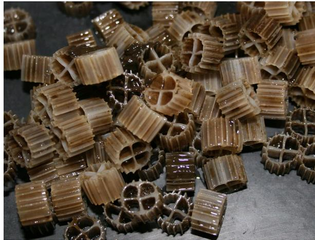
**Figure 27** : Biofilm sur le support Kaldnes® en fin d'expérimentation
