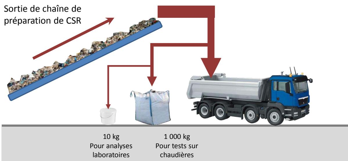
Figure 7 : Schéma de prélèvement des échantillons de CSR sur les sites de production
