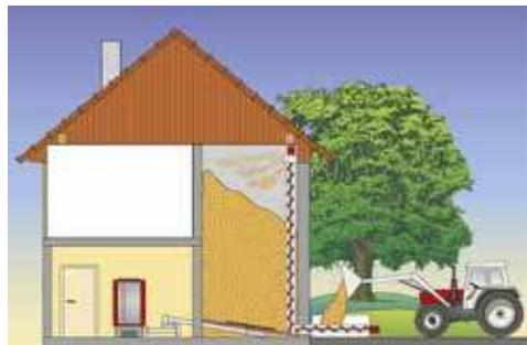
Remplissage d'un silo sur 2 niveaux.
