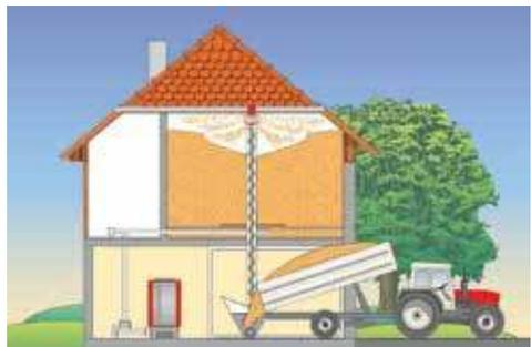
Remplissage d'un silo situé au 1<sup>er</sup> ou 2<sup>ème</sup> étage.
