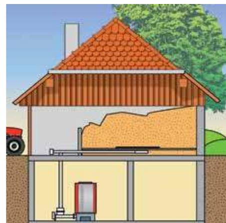
Silo au 1<sup>er</sup> étage avec remplissage direct et alimentation de la chaudière par tube de chute au RdC.
