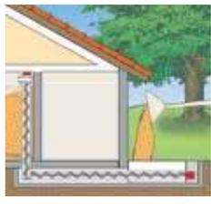
Trémie et vis enterrée dans le sol.
