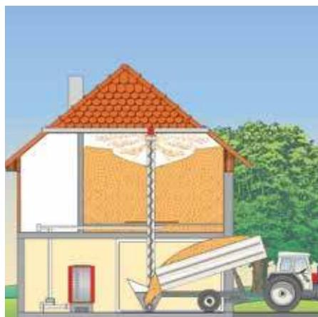
Grand silo au 1<sup>er</sup> étage avec remplissage par vis verticale et alimentation de la chaudière par tube de chute au RdC.
