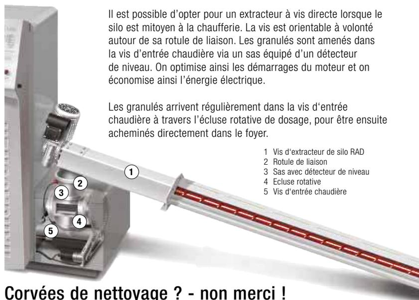
Il est possible d'opter pour un extracteur à vis directe lorsque le silo est mitoyen à la chaufferie. La vis est orientable à volonté autour de sa rotule de liaison. Les granulés sont amenés dans la vis d'entrée chaudière via un sas équipé d'un détecteur de niveau. On optimise ainsi les démarrages du moteur et on économise ainsi l'énergie électrique.
