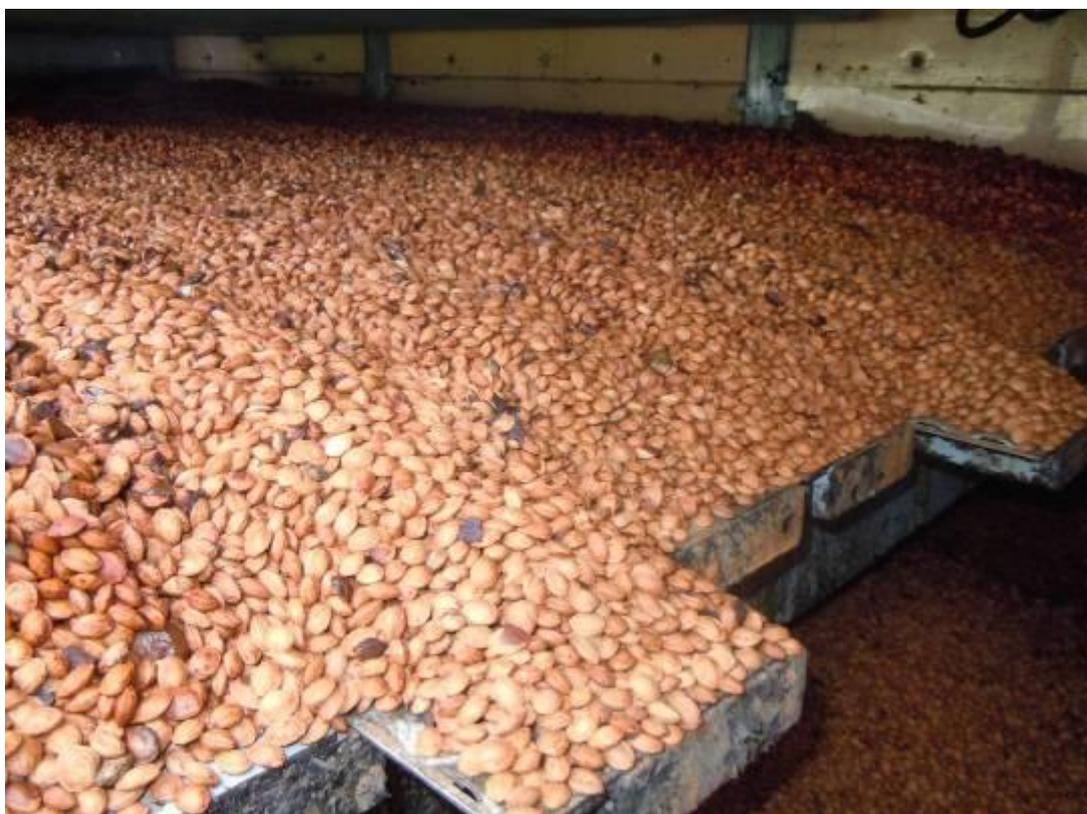
Noyaux bien séchés à la jetée du 2<sup>ème</sup> étage au 3<sup>ème</sup> étage
