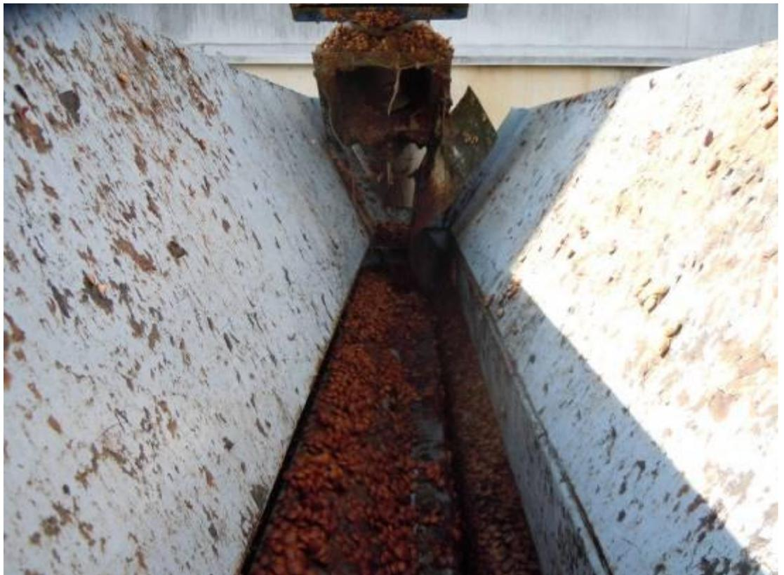
Arrivée des noyaux humides dans le niveau supérieur du fond mouvant (1<sup>er</sup> étage)
