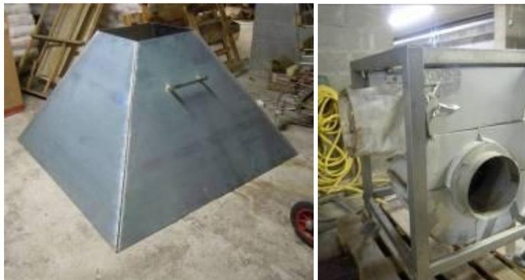
Capot et ventilateur de soufflerie (à la charge du client) avant le montage
