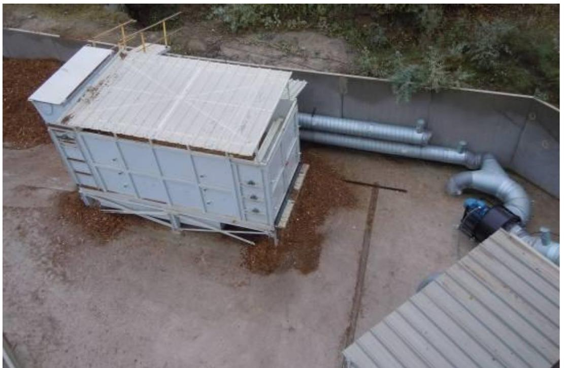
Vue du haut : machine à portes fermées (mode « séchage ») avec gros tuyaux d'arrivée d'air chaud venant du ventilateur (à droite)
