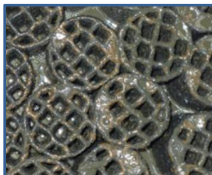
Figure 3 : Exemples de lit fixe (le filtre anaérobie d'Agrofutur à gauche, et la structure en nid d'abeille de Greenwatt à droite).
