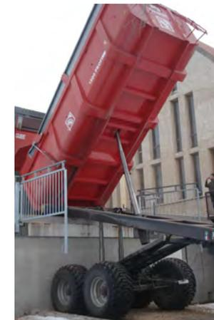
Benne élévatrice et basculante
