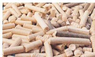
Les briquettes ou bûchettes reconstituées sont fabriquées à l'aide d'une presse à partir de copeaux et de sciures des scieries et des entreprises de la seconde transformation du bois. Elles se présentent sous la forme d'un cylindre de 30 mm de diamètre et de 20 à 50 cm de longueur.
