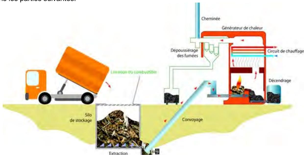
Figure 12 : Schéma d'une installation classique d'une chaufferie bois automatique (Source : [www.adhume.org](http://www.adhume.org))
