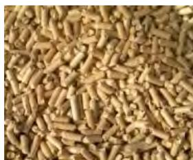
Utilisé pour la première fois aux États-Unis au milieu des années 1970 suite à la première crise pétrolière, le granulé, également appelé pellet, est un petit cylindre de sciure de bois très fortement compressée. Ce combustible très dense dispose d'un pouvoir calorifique minimum de 4 600 kWh par tonne avec une humidité sur poids brut du granulé de 8 %. Sa masse volumique est de 0,7 tonne/m<sup>3</sup>, ce qui facilite le transport et le stockage.
