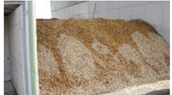
Exemple visuel de limite nette de séchage dans un tas de plaquettes.
