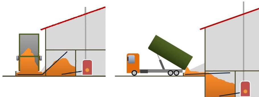
*Les systèmes de trémie et transfert par vis-sans-fin entraînent un allongement de la durée de livraison, et parfois une perte de volume utile.*
