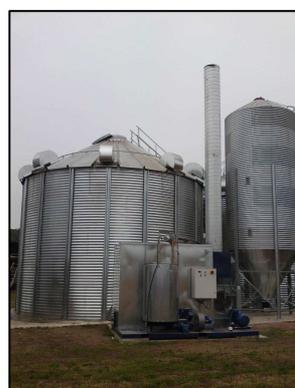
Photo 2: vues d'ensemble des cellules sécheuses équipées de générateurs d'air chaud indirect, Mabre (I)
