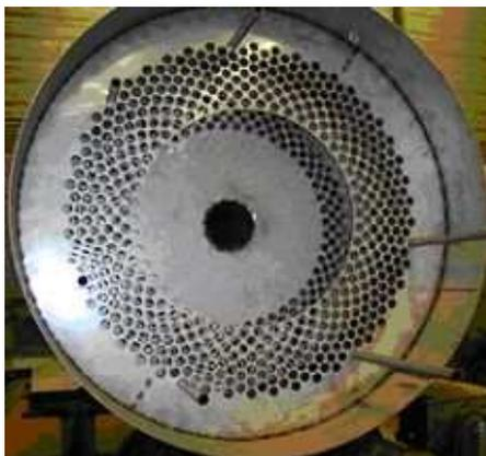
*Photo 3 : échangeur type à tubes de fumées à contre courant, Saacke (All)*
