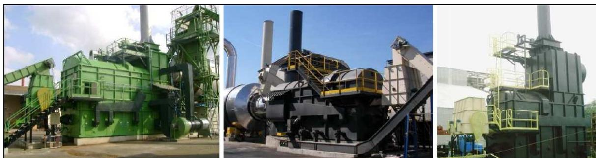
Photo 1 : générateur d'air chaud biomasse direct, mis en place dans des procédés de granulation bois, Next Energies (F)
